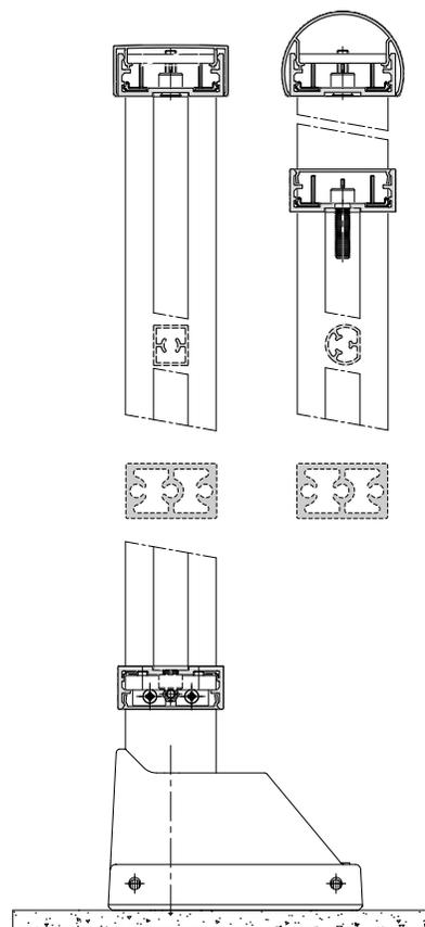
➤ DÉTAIL ASSEMBLAGE GC À BARREAUDAGE
